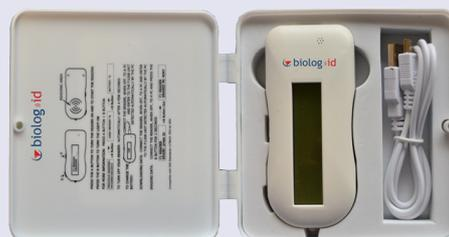
Le lecteur PRD 640 est un lecteur de transpondeurs ISO utilisant la fréquence 134,2KHz en FDXB. Il répond aux normes ISO 11784 et ISO 11785. Il est équipé en option d'une interface Bluetooth dont la portée est de 10 mètres en champ libre.
